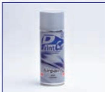
Pintura con alta concentración en zinc, idóneo para el galvanizado en frío de superficies metálicas, para proteger partes defectuosas o soldadas de las carrocerías galvanizadas, resistente hasta 490°C según normas DIN 50976,53167,50021,53151.
